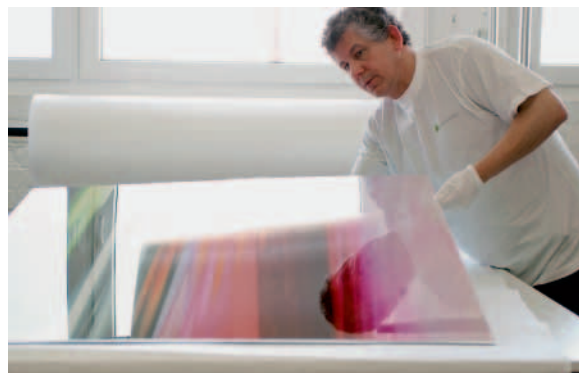
Knifflig: Hier erfolgt die Silikonversiegelung unter Acryl.
