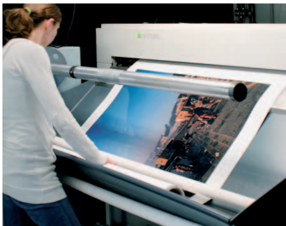
Hoher Durchsatz: Der Laserbelichter Lambda 130 gibt die fertigen Drucke in langen Bahnen aus.
